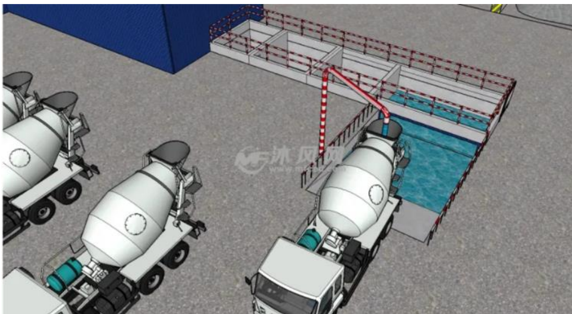
Слика бр.25: Прање ауто-миксера изнад таложника
